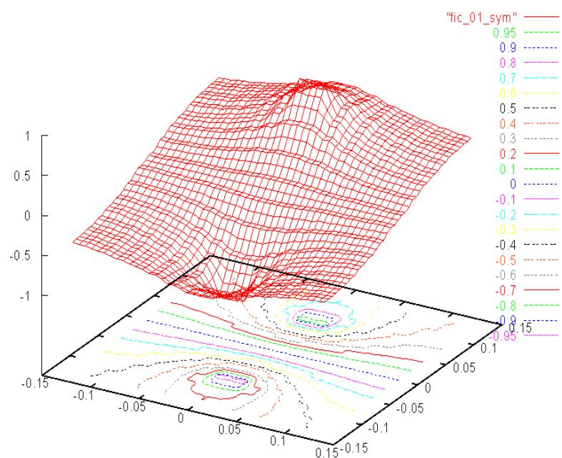
Potentiel entre 2 électrodes dans un domaine carré : mesures expérimentales visualisées avec gnuplot.
