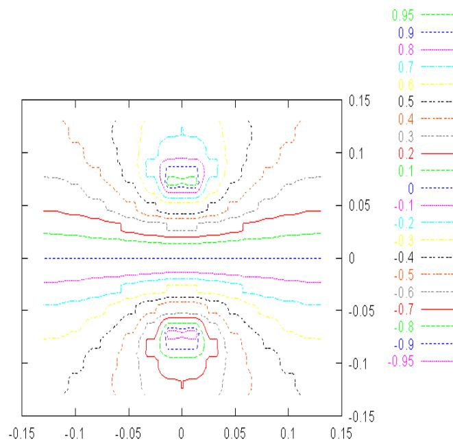
Equipotentielles autour de 2 électrodes rectangulaires dans un domaine carré : visualisation des mesures avec gnuplot.
