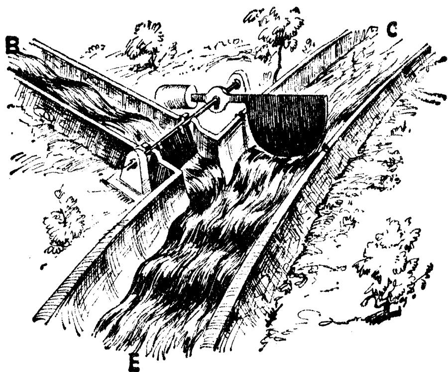
Le petit courant qui circule entre la base B et l'émetteur E est modulé. Le mouvement des petites vagues commande la grosse vanne : il en résulte un courant important entre le collecteur C et l'émetteur E, modulé en proportion du courant de base. Le signal modulé est amplifié par le transistor.
