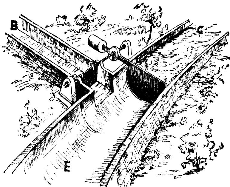
Une tension est appliquée entre le collecteur C et l'émetteur E du transistor : de l'eau est retenue par la grosse vanne.
