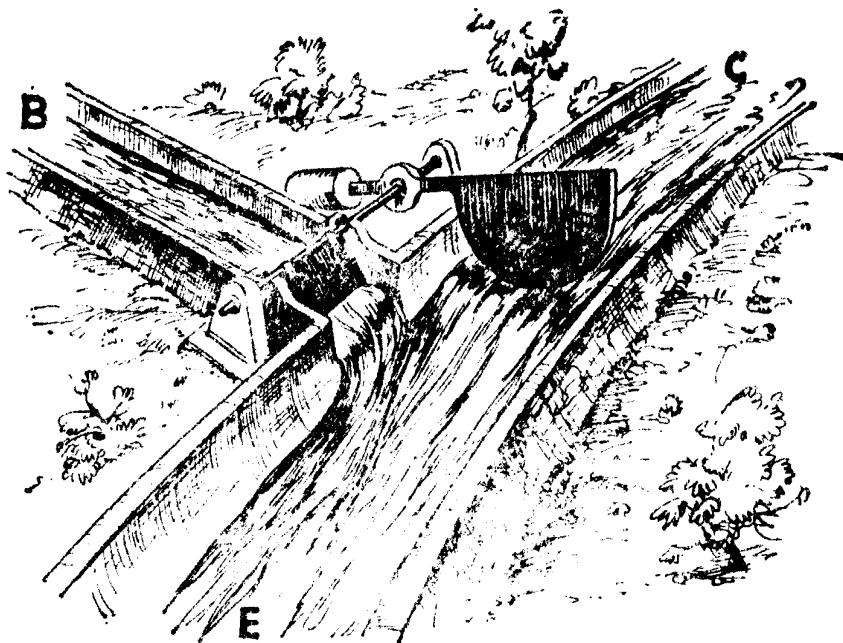
Un petit courant continu circule entre la base B et l'émetteur E du transistor. Ce petit courant fait s'ouvrir la grosse vanne et permet à un fort courant de circuler entre le collecteur et l'émetteur du transistor : il y a un effet amplificateur de courant.
